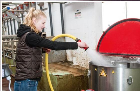
Вода для очистки циркулирует по шлангу и таким образом очищает резервуар, шланг и дозировочный пистолет изнутри.
